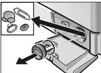
Als het sop niet volledig wordt afgepompt. Vreemde voorwerpen blokkeren de pomp of er werd bij hoge temperaturen erg pluizend wasgoed gewassen.
